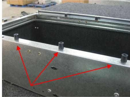
64. Montieren Sie das Stapel-Systemgehäuse am Haupt-System. Verwenden Sie die 6mm x 30mm Sechskant-Schrauben und Federscheiben.
