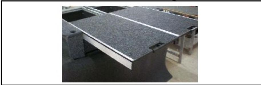
An den hinteren Innenseiten der Rollböden befindet sich ein blankes 6,2mm Loch im Metallgehäuse. Bohren Sie mit einem 6,2mm Bohrer das gleiche Loch in das Aluminium. Bohren Sie das gleiche Loch im gegenüber liegenden Rollboden in das Aluminium. Entfernen Sie die Bohrspäne am Aluminium.
