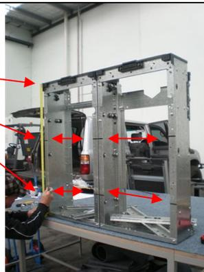
13. Verwenden Sie eine Ratsche, einen 10mm Nuss und einen 10mm Maulschlüssel und entfernen Sie die Oberteile.
