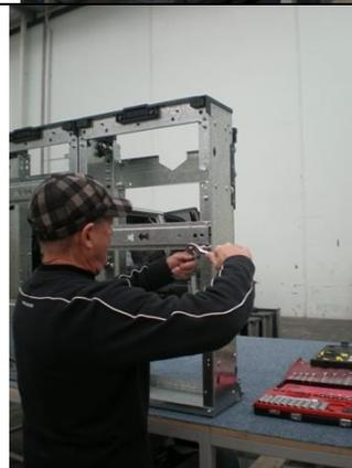
14. Verwenden Sie einen Hammer und klopfen Sie die C-förmigen Kanäle in die Oberteile, bis sie gleichmäßig anliegen.
